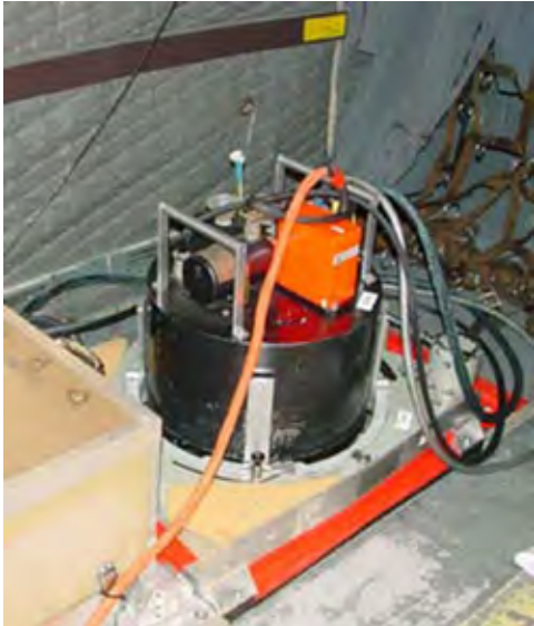
Abbildung 5: Konfiguration des Multispektralscanners DAEDALUS (Quelle: DLR)
