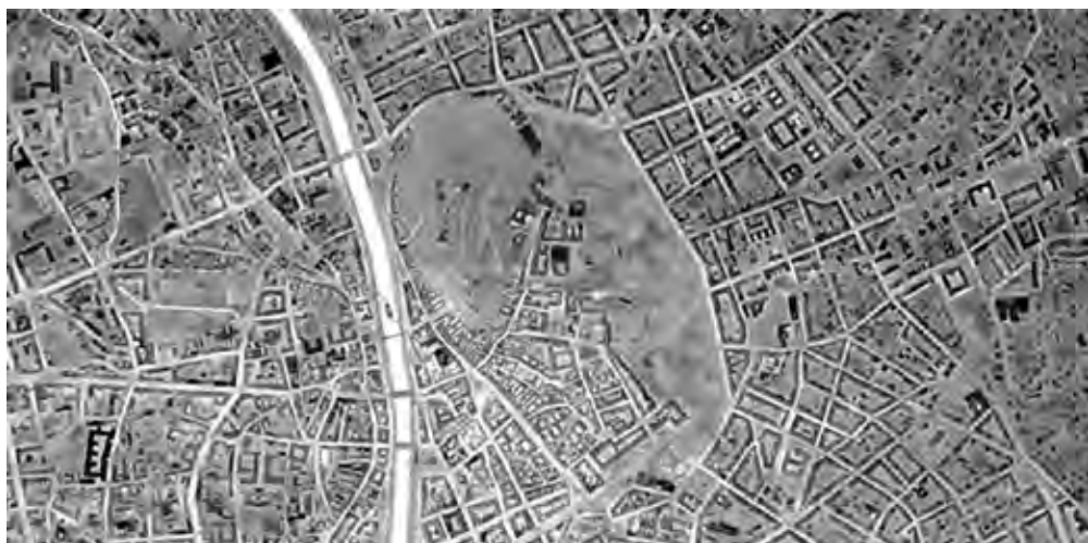
Abbildung 14: TABl-1800-Aufnahme vom 20.12.2011 (hell: warm, dunkel: kalt)
